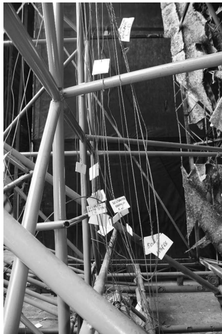
Foto 5. Etiquetas indicando o fio que movimenta cada elemento alegórico
